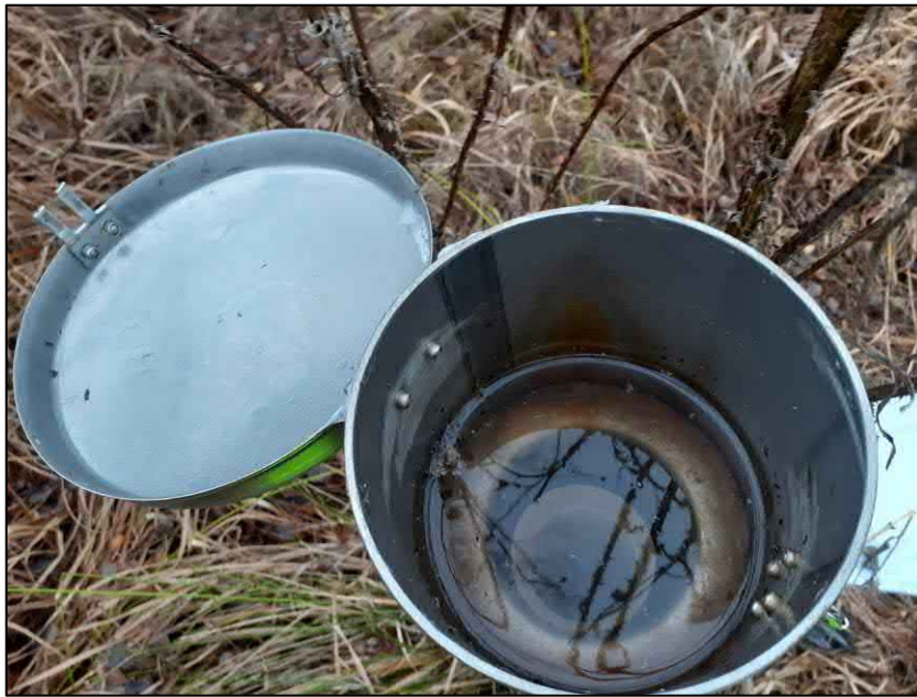
Kuva 3. Pohjaveden havaintoputki 1943, jossa on havaittu paineellista pohjavettä. Kuva on otettu 25.10.2019.
