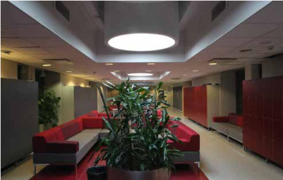
A) Vuonna 1977 valmistuneessa, arkkitehti Erik Kråkströmin suunnittelemassa lukion laajennuksessa eli B-osassa on syvän rakennusrungon keskelle luonnonvaloa tuovia, paikalla valetusta betonista tehtyjä, lieriönmuotoisia kattoikkunoita, joissa voidaan nähdä viitteitä Le Corbusierin arkkitehtuuriin.
