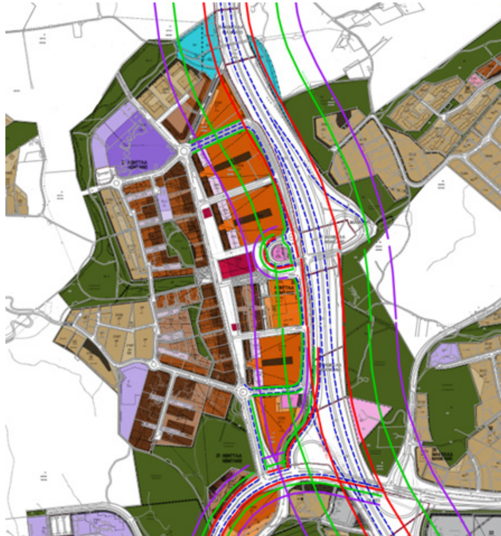
Kuva 9. HSY:n ilmanlaatuohjeistuksen mukaiset etäisyytvyöhykkeet Kehä II:n ja Henttaankaaren suhteen vuoden 2025 ennustetuilla liikennemääriillä. Punainen väri kuvaa minimietäisyyttä asumiselle ja vihreä väri vastaavaa suosituksetäisyyttä. Purppuran värinen viiva kuvaa herkkien kohteiden (päiväkodit, koulut) suosituksetäisyyttä Kehä II:sta.
