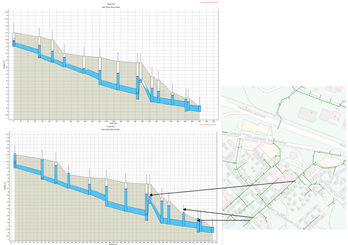
Kuva 18 Merivirran hulevesiviemärin pituusleikkaukset kahdella eri sateella tilanteessa, jossa verkosto on mallinnettu yhdistämällä verkostokartan ja mittausten korkotietoja. Sateet kerran viidessä vuodessa toistuva 30 minuutin sateella (ylempi kuva) ja kerran 100 vuodessa toistuva 15 minuutin sade (alempi kuva). Harvinaisemmalla sateella verkoston matalimman kaivot tulvivat.
