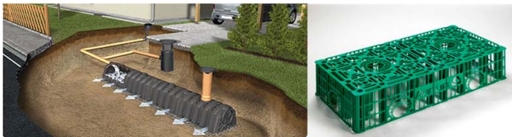
Kuva 5 Imeytyskasetin periaatekuva (Lähteet: vasen: Omataloyhtiö, oikea: Pipelife)
