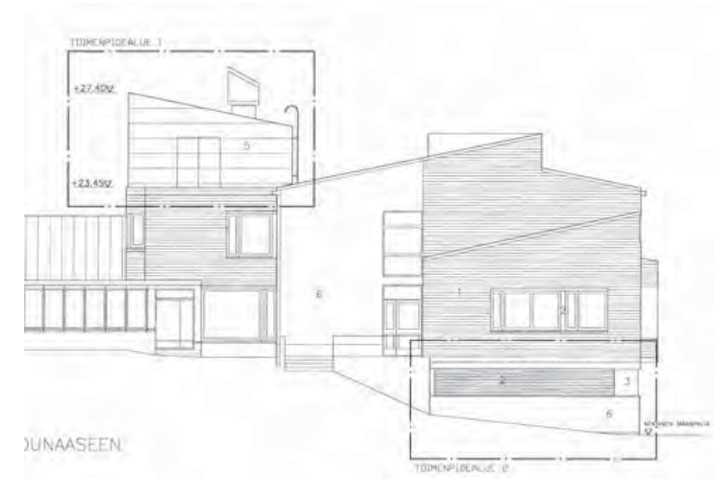
Julkisivu lounaaseen vuodelta 1998. Katolla uusi IV-konehuone ja siiven avonaisen lastauslaiturin seinä rakennettu umpeen. (eCity/Arksa: J1998-2209-B-P-10, osa.)
