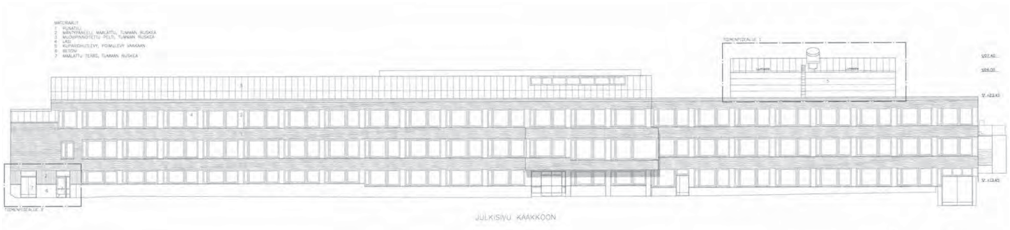
Ensimmäisen rakennusvaiheen siiven julkisivu kaakkoon vuodelta 1998. Katolla uusi IV-konehuone ja siiven avonaisen lastauslaiturin seinä rakennettu umpeen. (eCity/Arksa: J1998-2209-B-P-8.)
