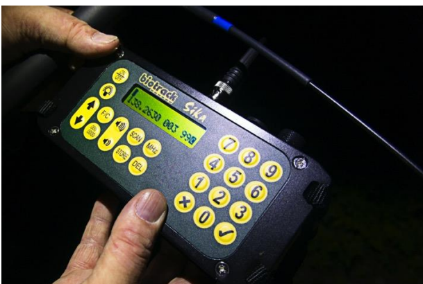
Kuvat 2-15 ja 2-16. Vastaanottimen näytöllä näkyy seurattavan yksilön numero ja pannan lähetystaajuus. Timo Metsänen peilaa signaalia antennin avulla Tapiolassa.
