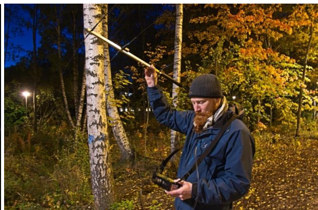
Kuvat 2-15 ja 2-16. Vastaanottimen näytöllä näkyy seurattavan yksilön numero ja pannan lähetystaajuus. Timo Metsänen peilaa signaalia antennin avulla Tapiolassa.
