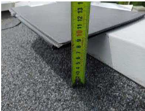
8.27. Mittausten perusteella on kattolyhtyjen räystäään padotuskorkeus nykyisten rakennusohjeiden mukainen. Räystäskallistukset ovat mittausten perusteella vähintään 4°.
