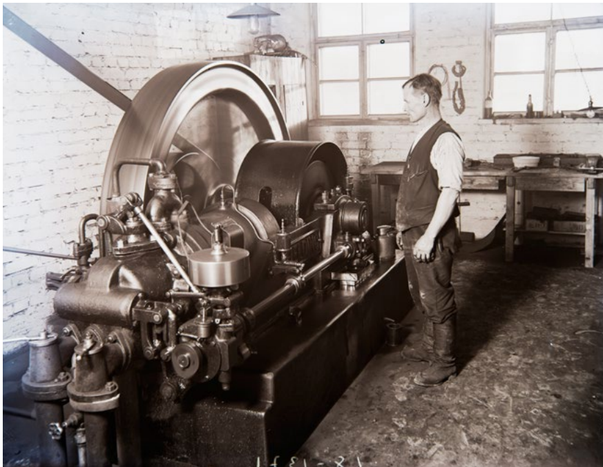
Imukaasumoottori pohjakerroksessa ennen v. 1945, EKM / M Mannelin
