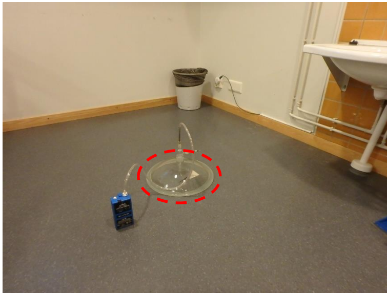
Kuva 1. Haihtuvien orgaanisten yhdisteiden näytteet otettiin ryhmähuoneen 212 sisäilmasta sekä muovimattopinnoitteen alta kohdennetusti ns. kupumittausmenetelmällä.
