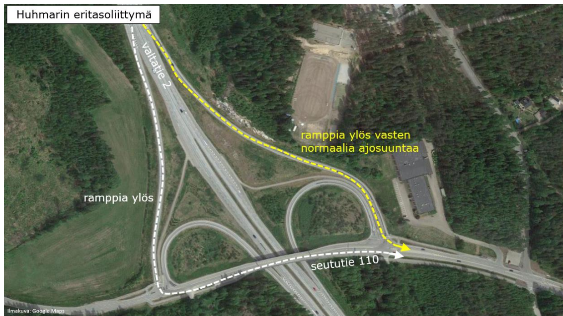
Kuva 17: Huhmarin eritasoliittymässä siipikuljetusten mahdolliset ajolinjat.
