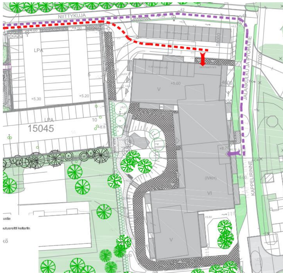
Kuva 21 Pelastuslaitos lähestyy kohdetta pohjoisesta.
