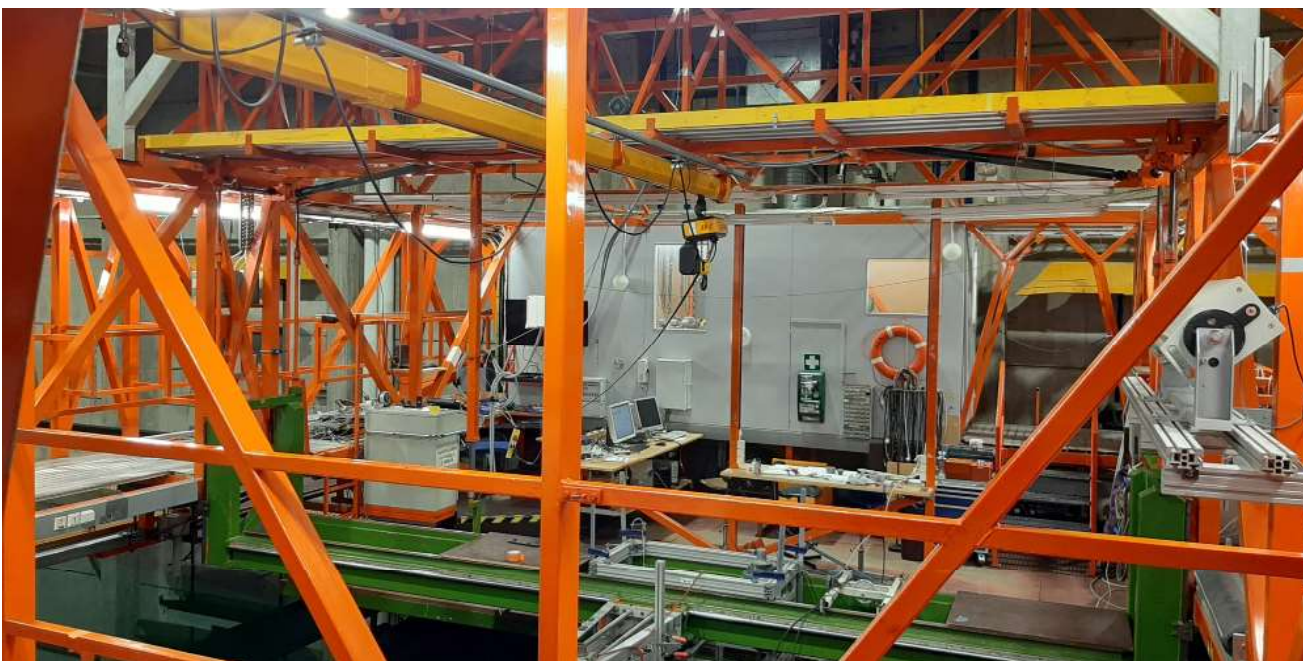
Tutkimusvaunun keskellä sijaitsee mittauskenttä. Laivalaboratorion alkuaikoina kuvassa näkyvä harmaa kontti oli pääosin tietokonetta. Sittemmin laitteistot ovat kehittyneet.
