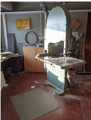
Puutyöpajan vannesaha ja tasohöylä. Jokaisen työkoneneen ja -tason kohdalla on muovimatto, joka parantaa kitkaa.
