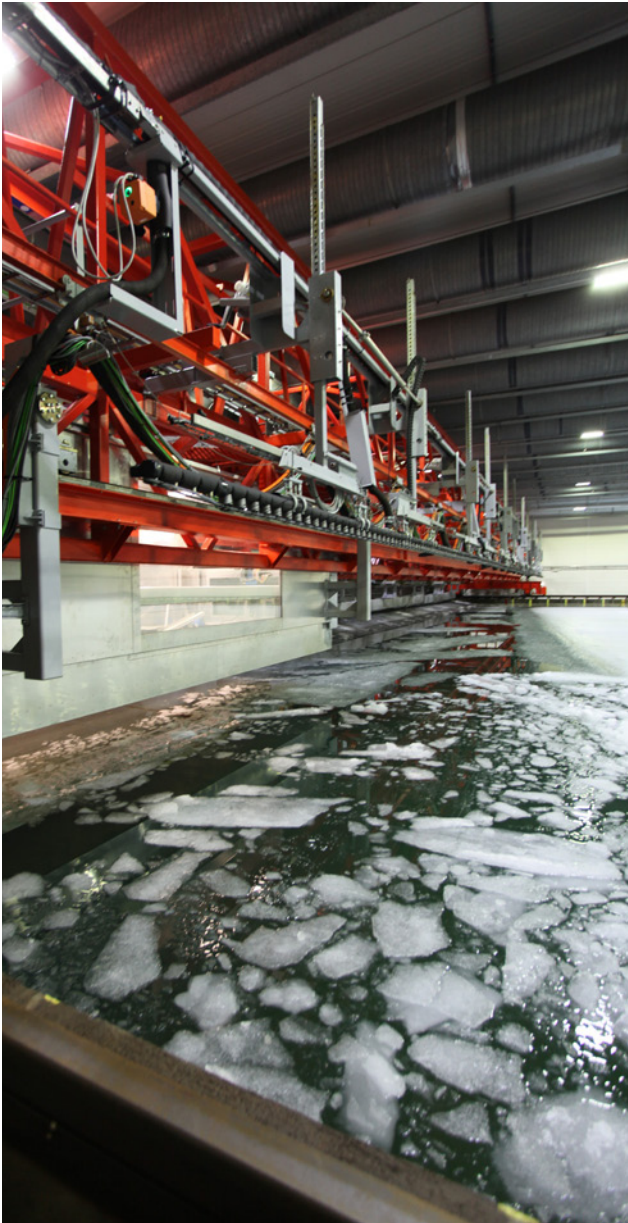
Kuva oikealla: Jääkoealtaaseen vuonna 1988 muutostöissä lisätty tutkimus- ja havainnointivaunu.
