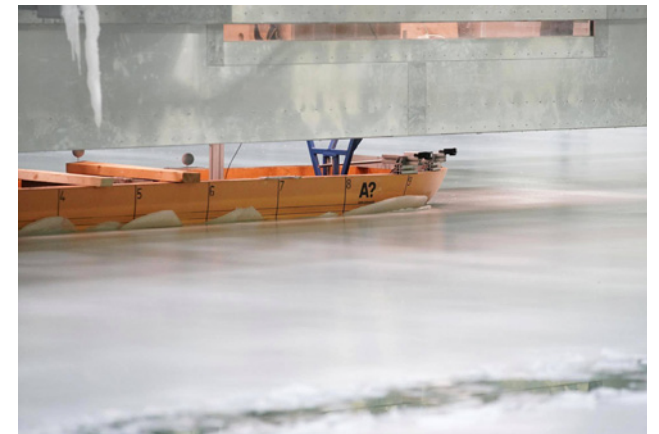
Kuva yllä: Tutkimus- ja havainnointivaunu eli ns. xy-vaunu mahdollistaa jään tutkimisen ja kokeiden tekemisen rikkomatta jään pintaa.
