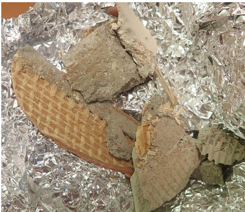
Kuva 9. Linoleum-lattiapinnoitteesta ja tasoitteesta otettiin materiaalinäyte haihtuvien orgaanisten yhdisteiden määrittämistä varten.
