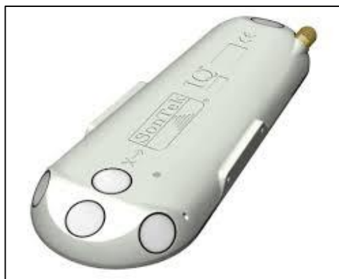
Kuva 1. Syvyys- ja virtaamamittauksissa käytetty mittauslaitteisto Sontek M9 (vasemmalla) ja pohja-asennuksessa käytetty Sontek IQ -virtaamamittari (oikealla).
