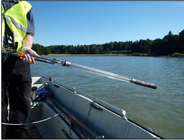
Kuva 16. Sedimenttinäytteenottoa Multisampler-näytteenottimella elokuussa 2015.
