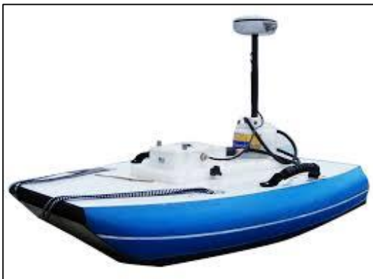
Kuva 1. Syvyys- ja virtaamamittauksissa käytetty mittauslaitteisto Sontek M9 (vasemmalla) ja pohja-asennuksessa käytetty Sontek IQ -virtaamamittari (oikealla).
