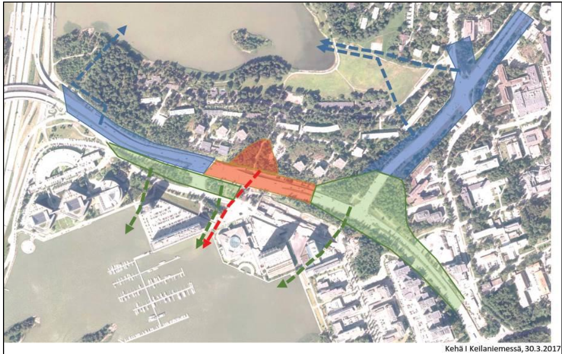
Kuva 11. Hulevesien johtaminen nykytilanteessa ennen Kehä I Keilaniemessä hankkeen toteutusta.
