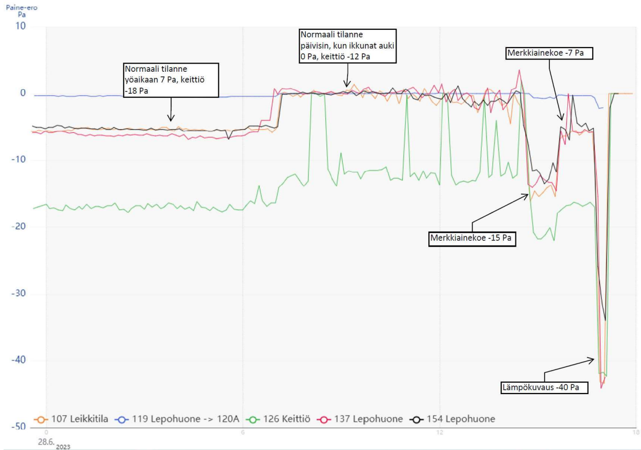
Kuva 10. Paineroseuranta tiloissa 107, 119, 120A, keittiö, 137 ja 154. Tilat ovat öisin alipaineisia n. -7 Pa, keittiö -18 Pa. Päivisin kun ikkunat ovat auki paine-ero tasoittuu. Merkkiainekokeiden ajaksi tilat alipaineistettiin n. -15 pa. Lämpökuvauksen ajaksi tilat alipaineistettiin n. -40 Pa.
