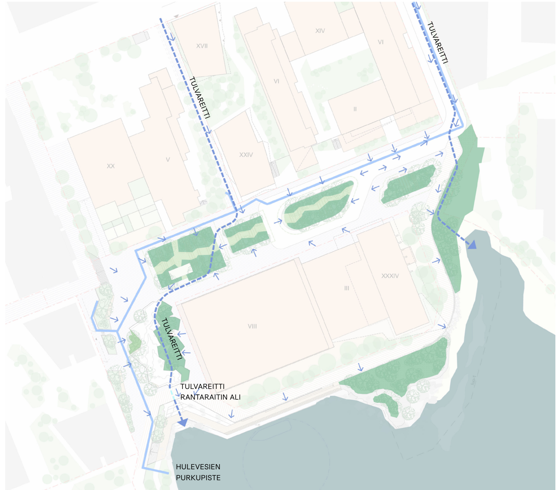
Kuva 34. Hulevesikaavio 1:1000. Pintavalunnan suunta ja tulvareitit
