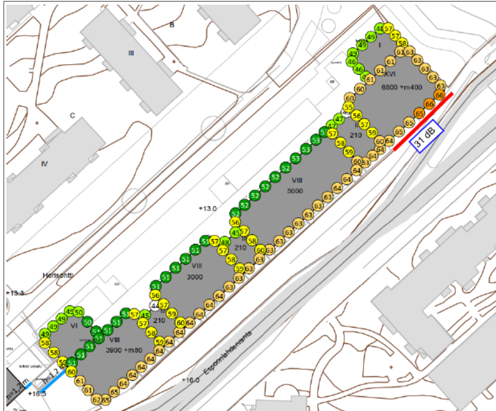
Kuva 22: Kortteliin kohdistuvat suurimmat julkisivun päivämelutasot
