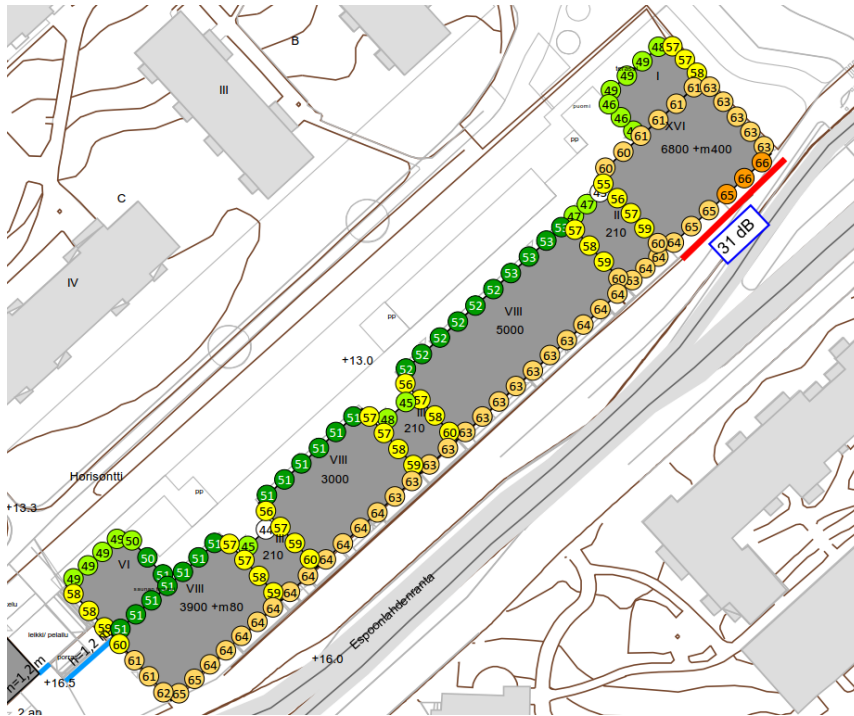
Kuva 5.2.1. Ehdotus julkisivun äänieristuksen kaavamääräykseksi
