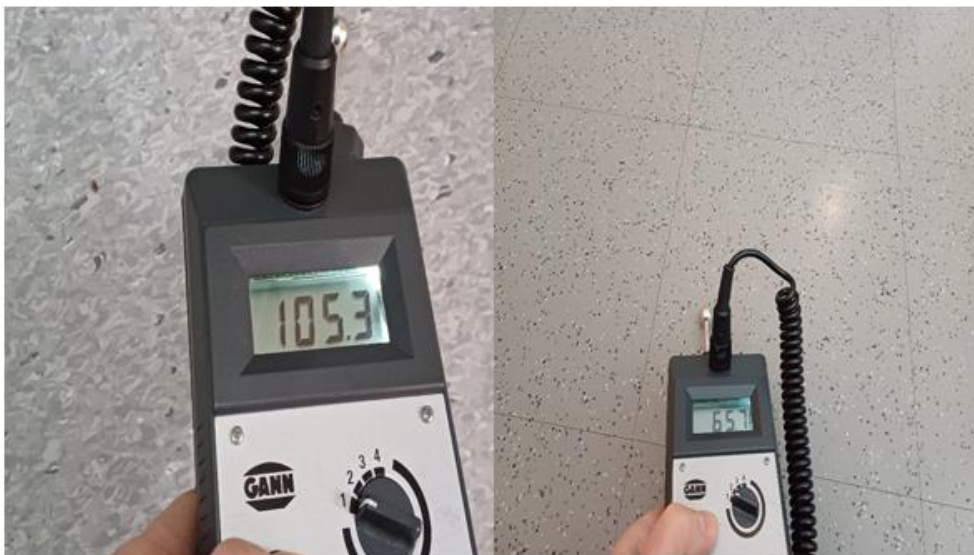
Kuva 4.4. 124 Porrashuoneen alatasen lattiassa havaittiin kohonneita pintakosteusilmaisimen vertailulukemia.
