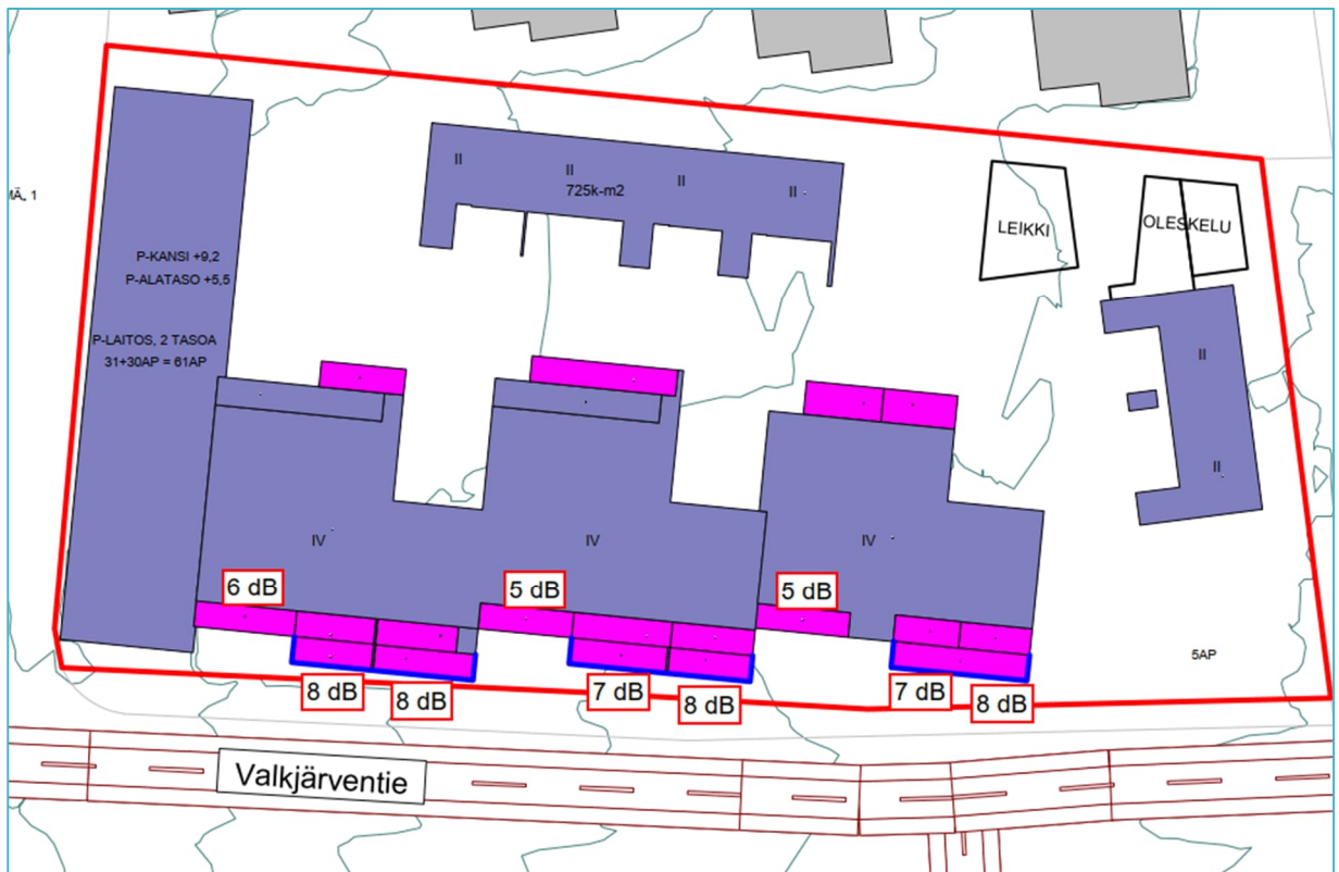
Kuva 3. Suositukset lasitettujen parvekkeiden läänitasoerovaatimuksista \Delta L_{A,vaad} . Arkkitehtisuunnitelmien mukaiset parvekkeet on esitetty pinkillä värillä. Sisäpihan puolella parvekkeet tulee varustaa lasituksen, mutta näitä parvekkeita ei ole tarpeen mitoittaa liikennemelua vastaan.
