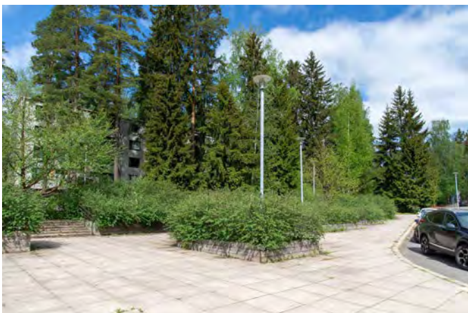
Jalankulkualueiden pinnoitteena on käytetty 700 x 700 mm betonilaattoja.
