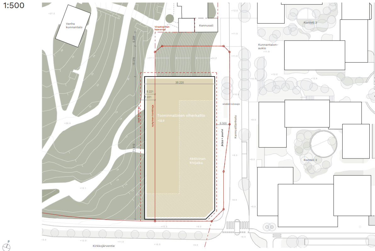
Kuva 9. Alustava asemapiirros uudesta pysäköintitalosta. Kuvaan on esitetty punaisella katkoviivalla alustava uusi tonttiraja. Punainen viiva osoittaa nykyisen LPA-korttelialueen rajan. Rakennuksen sijainti ja laajuus tarkentuvat suunnittelun edetessä. Kuva ei mittakaavassa. Kuva: Cobe A/S & Lundén Architecture Company Oy.
