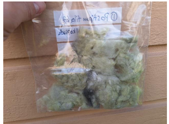
Kuva 18 Villanäyte 1, jossa on hieman tummentumaa. Näyte otettiin ulkopinnasta.
