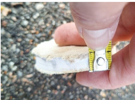
Kuva 29 Kipsilevy on 9 mm paksua.
