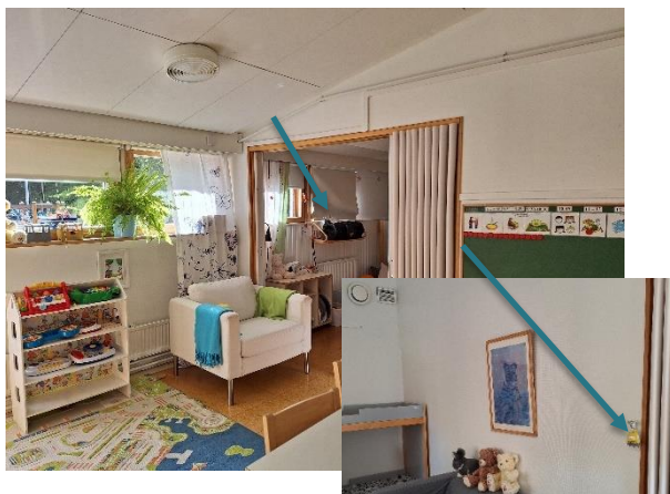
Kuva 62 Vertailutilan 4 seurannat. Lämpötila- ja kosteusseuranta on tilojen välioiven luona.
