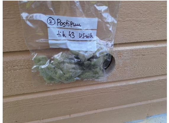
Kuva 22 Näyte 2 eristeestä sisälsi hieman tummentumaa.
