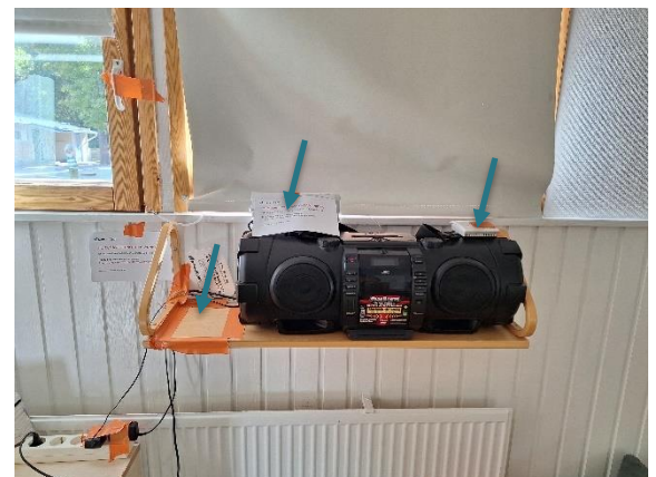
Kuva 63 Vertailutilan 4 hiilidioksidi- ja paine-eroseurannat sekä kuitunäytteiden ottopaikka.
