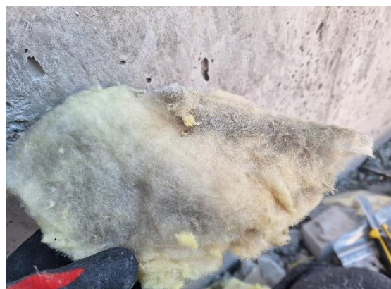
Kuva 44 Taaempänä eristevillassa oli hieman tummentumia.
