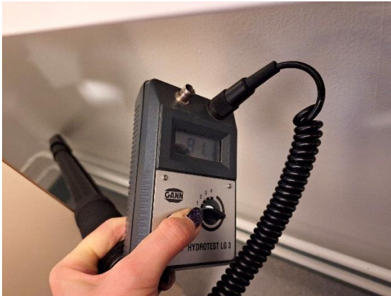
Kuva 17 Ulkokulman alaosassa kosteus nousi ollen 80...84, vrt. 55.
