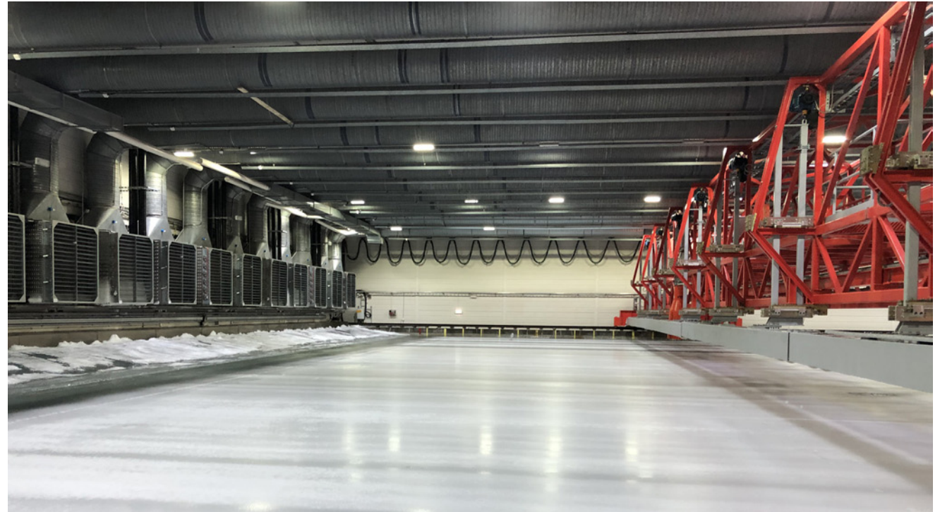
Kuva oikealla: Jääkoealtaaseen vuonna 1988 muutostöissä lisätty tutkimus- ja havainnointivaunu.
