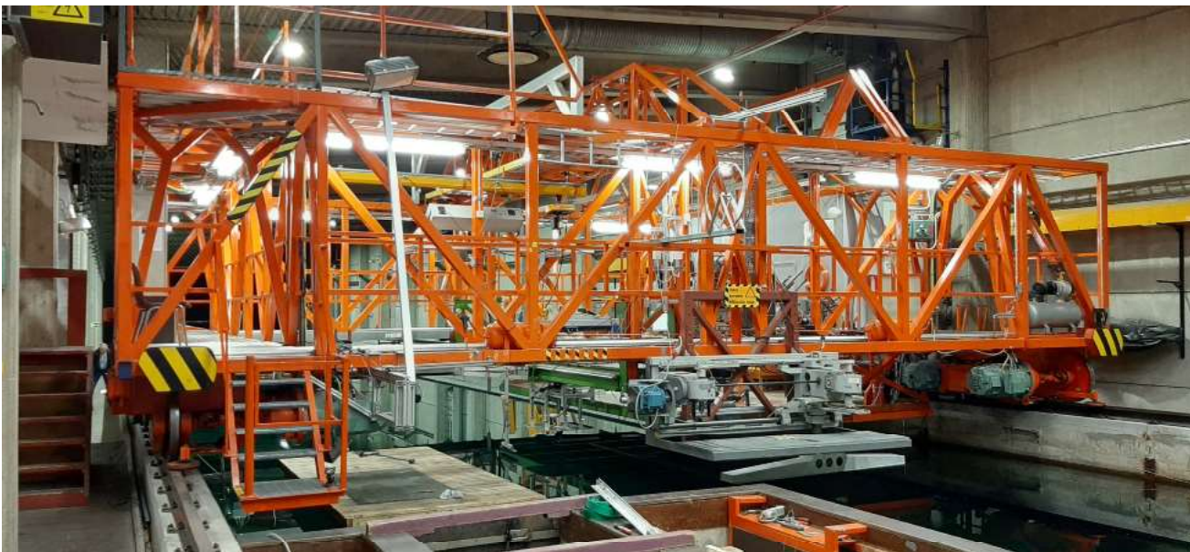
Tutkimusvaunu mallikoehallin itäpäästä kuvattuna.
