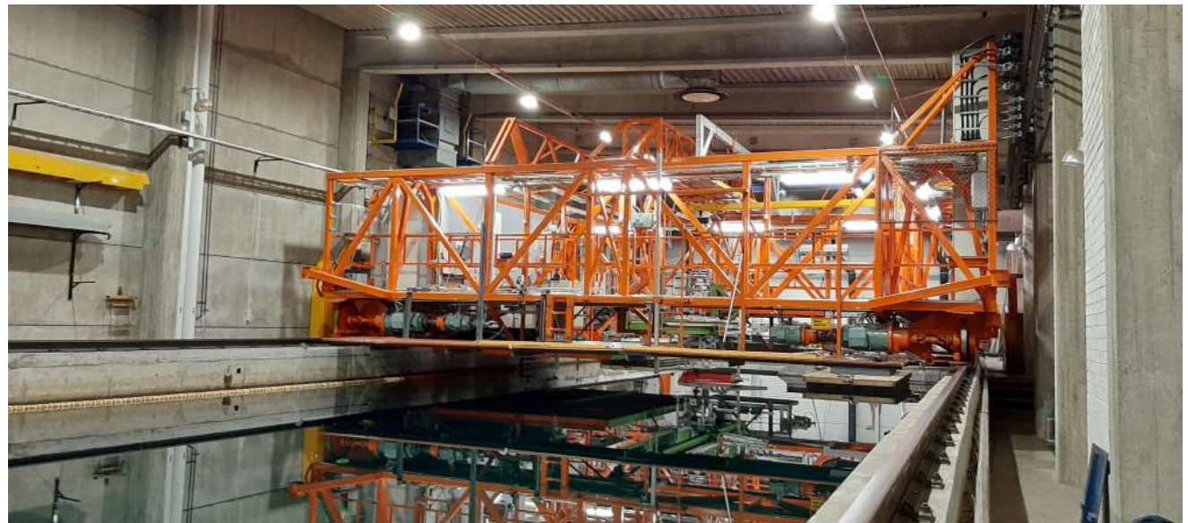
Oranssi tutkimusvaunu on yksi tilan keskeisistä elementeistä. Sillä voidaan liikuttaa malliveneitä ja tehdä kokeita.
