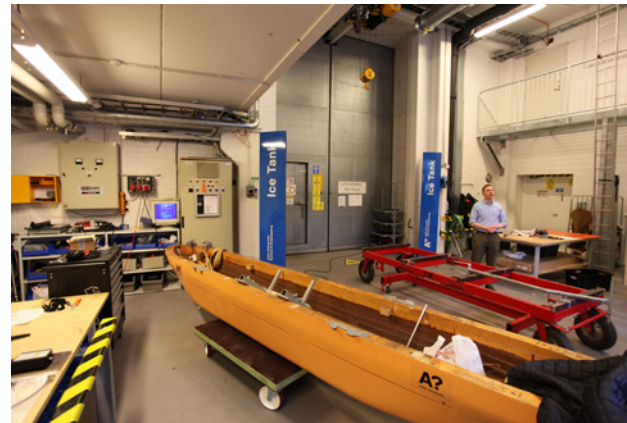
Osa mallien varustelutilasta on matalampaa, sillä yläpuolella sijaitsee jäälaboratorion valvomo.
