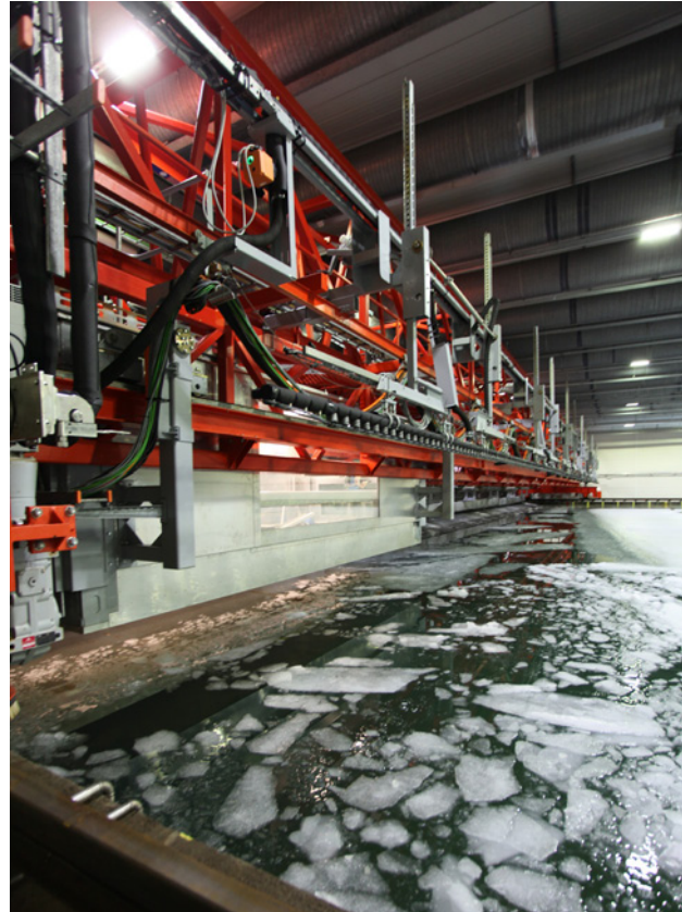
Jääkoealtaan yli kulkeva teräsrakenteinen xt-rainu on väritään pääosin punainen.
