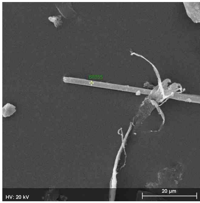
Kuva 8. Elektronimikroskooppikuva näytteestä PP8. Kuvassa lasivillakuitu.
