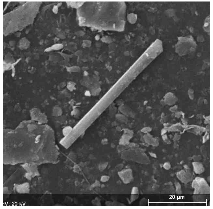
Kuva 4. Elektronimikroskooppikuva näytteestä PP4. Kuvassa lasivillakuitu.
