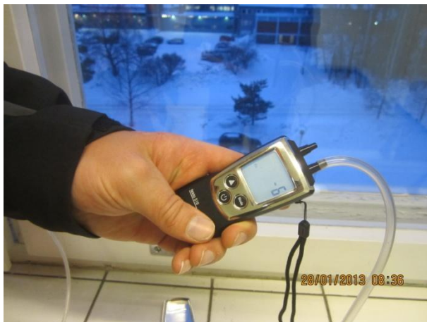
Kuva 25 Sisätilat olivat alipaineisia.
