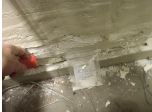
Kuva 18 Mikroninäyte 4 keskustilan seinän kosteusvauriokohdalta sisältää mm. akti-nomykeettejä.
