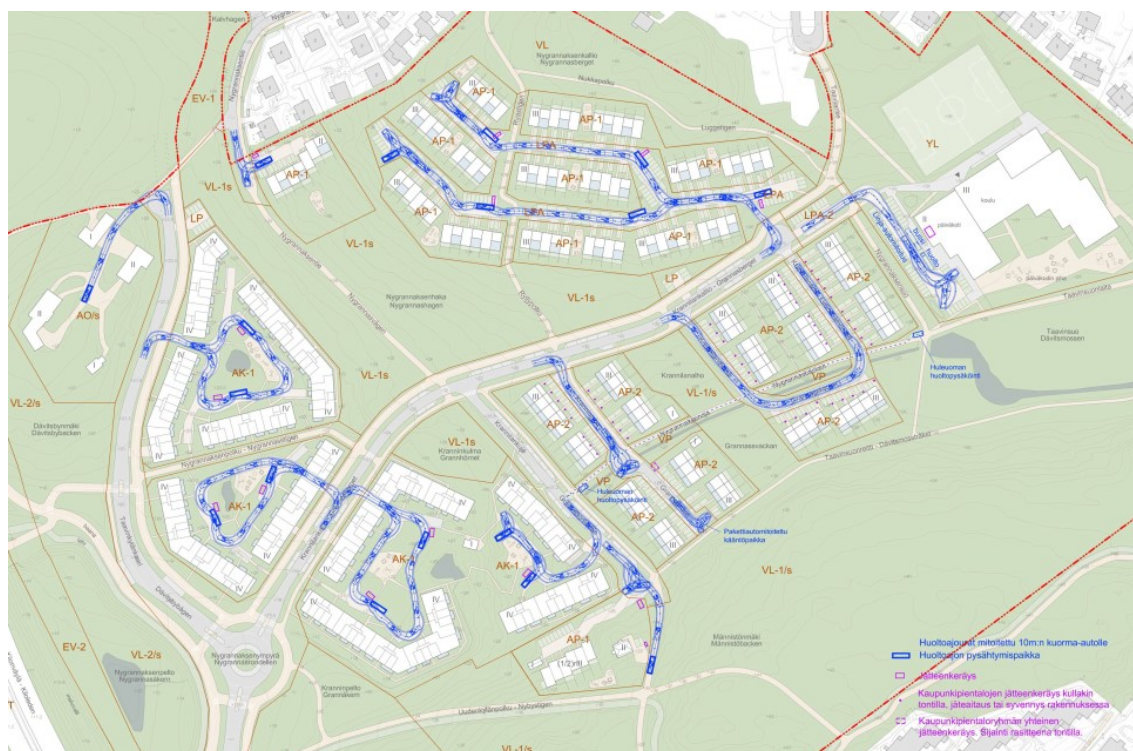
Kuva: huoltoajoneuvon (10 m pitkä ajoneuvo) ajouratarkastelu.
