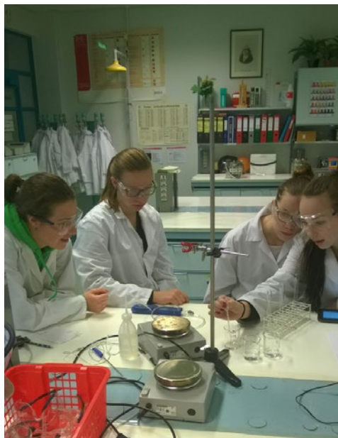
Opiskelijat vertailevat reaktioiden nopeuksia mittaamalla reaktiossa muodostuvan kaasun paineen muutosta tablettitietokoneen avulla
