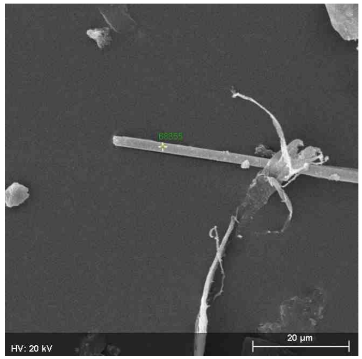
Kuva 8. Elektronimikroskooppikuva näytteestä PP8. Kuvassa lasivillakuitu.
