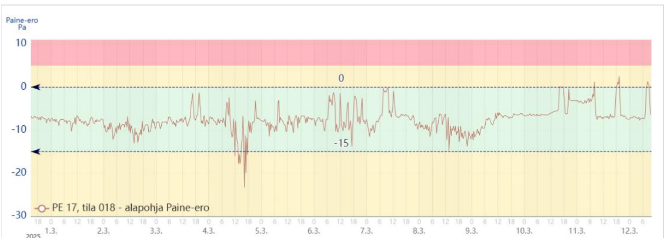
Kuva 23. Kotitalousluokassa 2 (tila 018) seurattiin sisäilman ja ryömintätilan välistä paine-eroa. Kotitalousluokka 2 oli keskimäärin -7,5 pascalia alipaineinen ryömintätilaan nähden.
