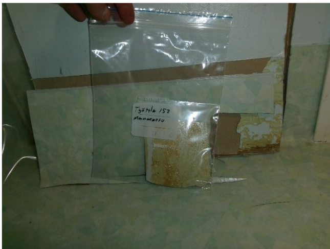
Kuva 3. 152 työtilan muovimatossa todettiin DEHP ja TXIB pitoisuuden ylittävän vaarallisen jätteen raja-arvon.
