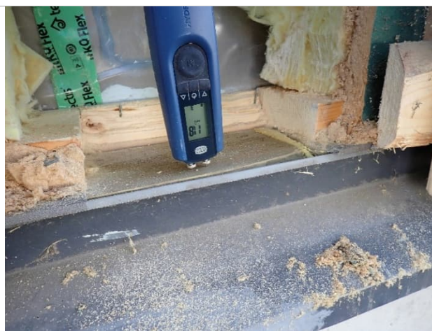
Kuva 41. RA16 alaohjauspuusta mitattiin tavanomaisia kosteusarvoja 12 p%
