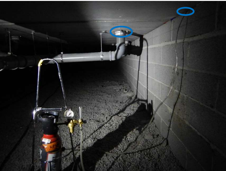
Syöttö sokkelin ja alapohjan liittymään. Takana on viemäri, jonka juureen syötettäessä havaittiin ilmavuotoa sisätiloissa.
