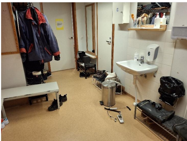
Kuva 17. Viiltokosteusmittaus VK2 tehtiin työntekijöiden pukuhuoneeseen 123. Suhteellinen kosteus oli tavanomainen (68,2 % RH, 18,4 °C, 10,7 g/m 3 ), mutta liima vaikutti hie-man saippuoituneelta.
