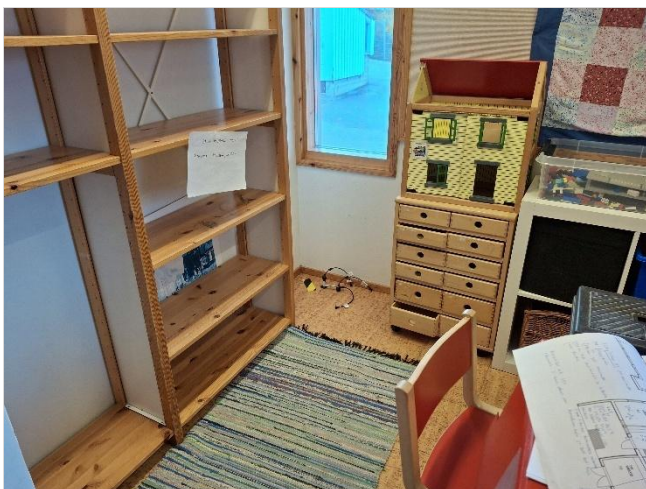
Kuva 25. Kuraeteisen 155 viereiseen tilaan 156 tehtiin kontrolloiva porareikämittaus PR2, leikkutilassa alapohjalaatan suhteellinen kosteus oli normaali 63,2-73,7 %, 17,4 °C, 9,4-10,9 g/m³.
