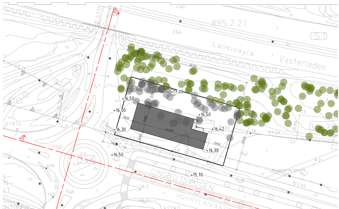
Kuva: Asemapiirros sähköaseman tontista, alustava (Kivinen-Rusanen arkkitehdit)
