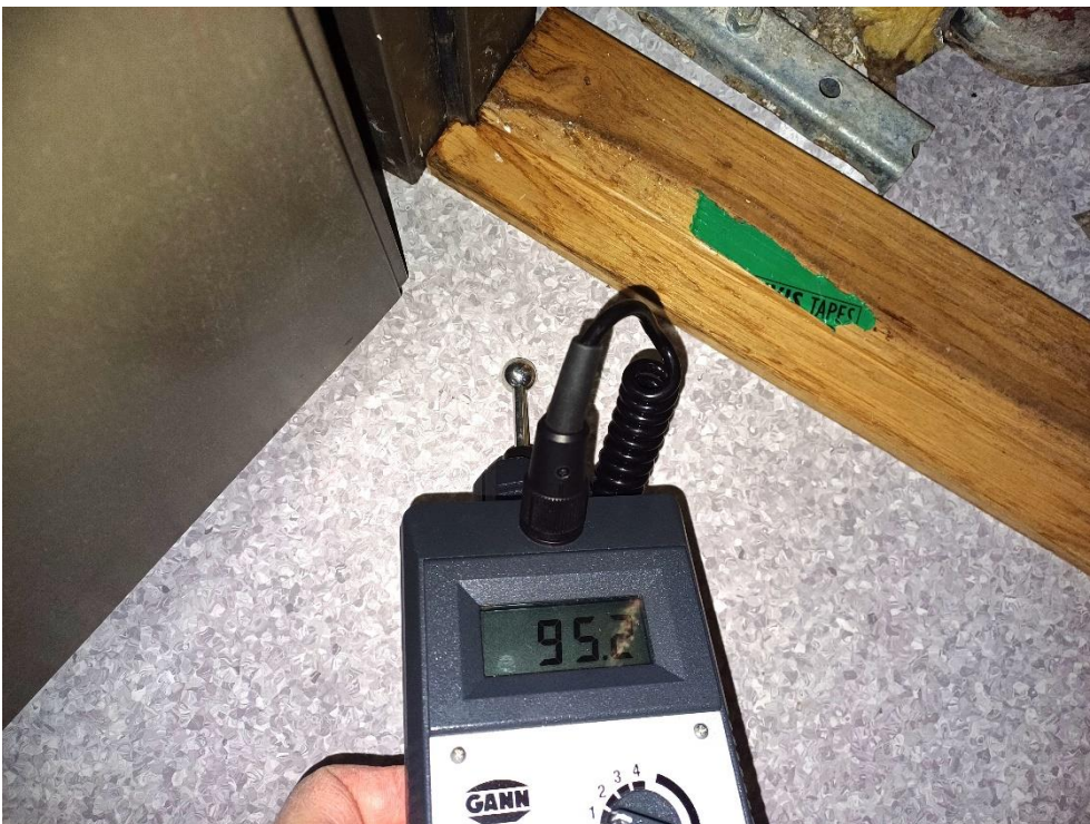
Kuva 4.3. 2.31 Luokka, tekniikkakanaalin oven edestä mitattiin pintakosteudenosoittimella kohonneita vertailuarvoja.
