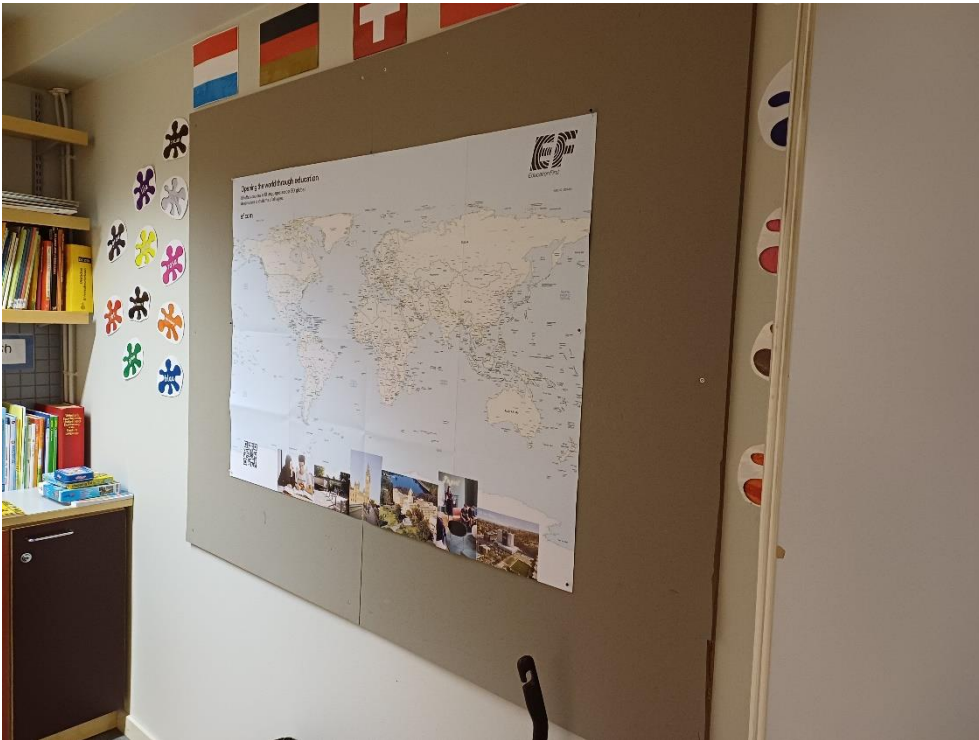
Kuva 4.8. Molempiin luokkatiloihin on asennettu ilmoitustauluja, joidenka materiaalista irtoaa aistinvaraisesti hieman hajua, mikä saattaa heikentää sisäilma laatua.
