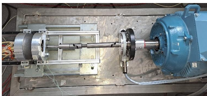
Kuva 10.8. Sähkömoottori testattavana Light eDynolla.
