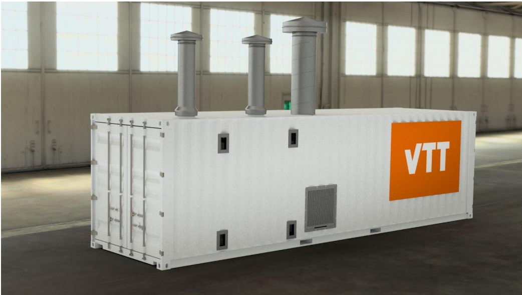
Kuva 10.11. Konttiin rakennettu PEM elektrolyysi testilaitteisto.
