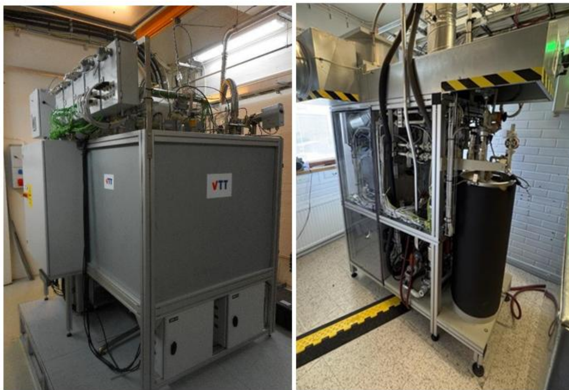
Kuva 10.10. SOC (vasen) ja PEM (oikea) elektrolyysikennostotestiasemat.
