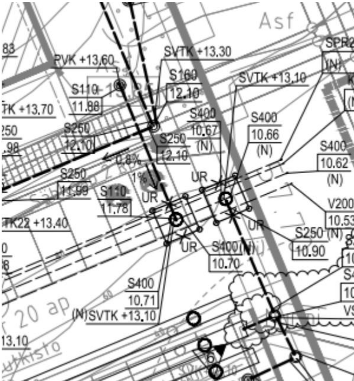
Kuva 28.2.2. Uudisrakennuksen kaakkoispuolen hulevesiliitoksien paikat.
